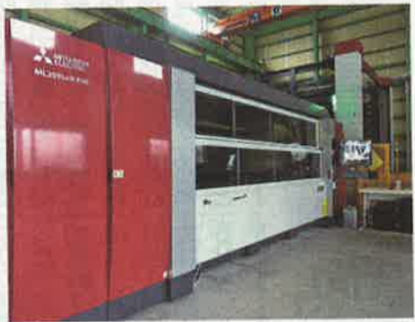
本稼働したストッカー付き新鋭ファイバーレーザ加工機⑤と新設した専用工場棟
